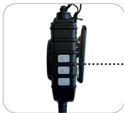
Lautstärkereglern +/- und Stummtaste (optional für Lautsprecher oder Mikrofon)
