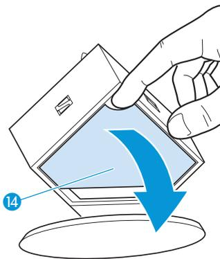
Um die Abdeckung anzubringen und um angeschlossene Kabel zu sichern:
