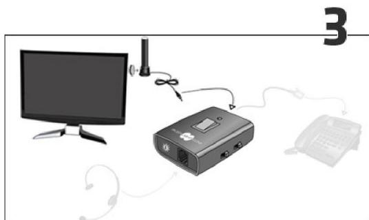
3. Stecken Sie die Busylight-Lampe in den Busylight-Adapter und befestigen Sie die Lampe an einen gut sichtbaren Ort. Vermeiden Sie direkte Sonneneinstrahlung.
