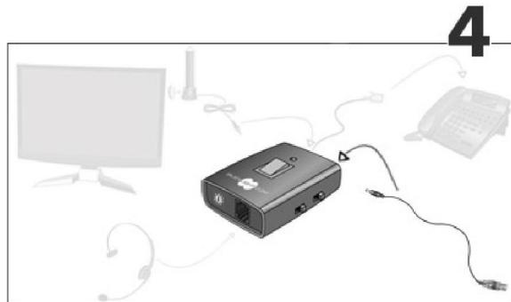
4. Verbinden Sie nun den Busylight-Adapter, zur Stromversorgung, mit dem USB-Kabel an den PC oder an ein USB-Netzteil.
