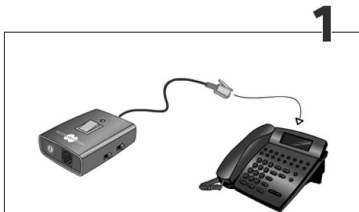
1. Stecken Sie das Anschlusskabel des Busylight-Adapters in die Headset-Buchse des Telefons.
