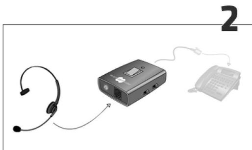
2. Stecken Sie nun das Anschlusskabel des Headsets in die vordere Buchse des Busylight-Adapters.
