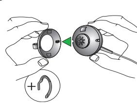
**Keuze draagkant (L of R)****Trageseite wechseln (L bzw. R)****Cambio di orecchio (L o R)**
