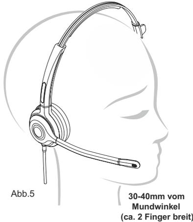
Um die Mikrofonkrümmung zu justieren, halten Sie den Mikrofonarm (wie in Abb. 6 zu sehen) mit beiden Händen. Bitte beachten Sie, dass Sie nicht das Ende des Mikrofons biegen, da dies zu einer Beschädigung führen könnte (Abb. 5).
