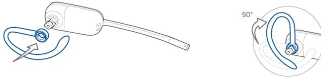
**HINWEIS** Stellen Sie sicher, dass der Ohrbügel vor dem Drehen flach am Headset anliegt.
