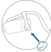
**HINWEIS** Stellen Sie sicher, dass das breite Ende des Ohrstöpsels zum Mikrofon zeigt.
