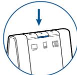
**HINWEIS** Wenn Sie einen Aufruf mit einem Mobiltelefon tätigen, ohne vorher die Mobiltelefon-Taste an der Basisstation gedrückt zu haben, verbleibt das Audiosignal auf dem Mobiltelefon. Wenn Sie das Audiosignal auf Ihr Headset übertragen möchten, drücken Sie kurz die Mobiltelefon-Taste an der Basisstation.
