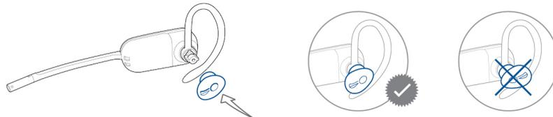
**HINWEIS** Stellen Sie sicher, dass das breite Ende des Ohrstöpsels zum Mikrophon zeigt.
