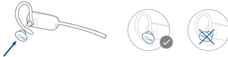
**HINWEIS** Stellen Sie sicher, dass das breite Ende des Ohrstöpsels zum Mikrofon zeigt.
