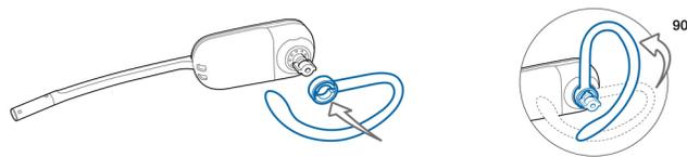
**HINWEIS** Stellen Sie sicher, dass der Ohrbügel vor dem Drehen flach am Headset anliegt.
