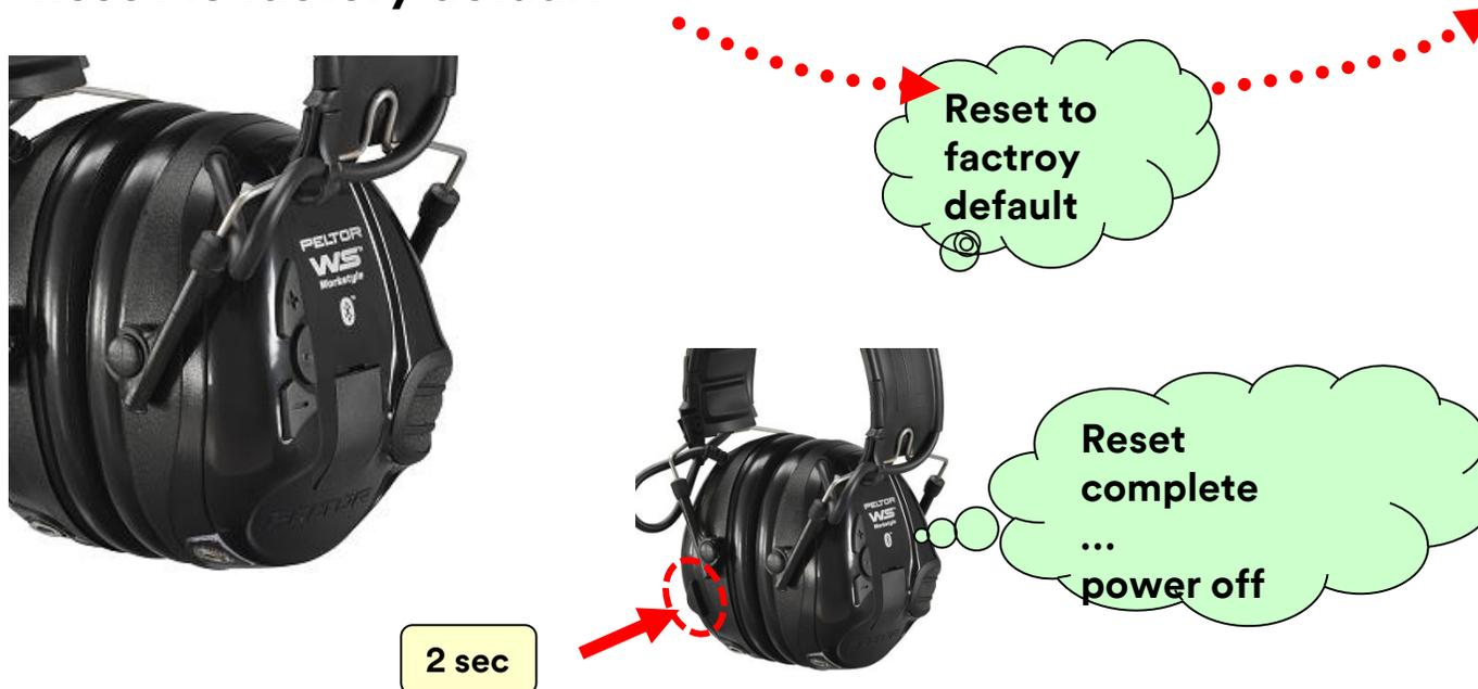
**i** Um den Reset auszuführen, muss nach der Auswahl dieses Menüpunktes die Bluetooth-Taste für 2sec gedrückt werden
