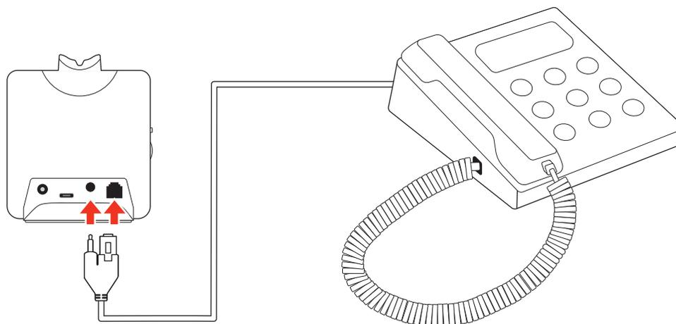
**Wichtig:** Verwenden Sie die Konfiguration „A“ an der Rückseite der Basisstation, die für die meisten Telefone einschließlich Cisco-Telefone geeignet ist.
