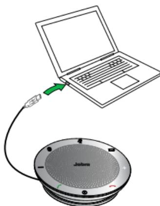
Schließen Sie das USB-Kabel des Jabra Speak 510 an einen beliebigen un belegten USB-Anschluss an Ihrem PC an, um den Akku aufzuladen. Die Akku-Kontrollleuchte leuchtet während des Ladevorgangs rot. Ist der Ladevorgang beendet, leuchtet sie grün (1 Minute).
