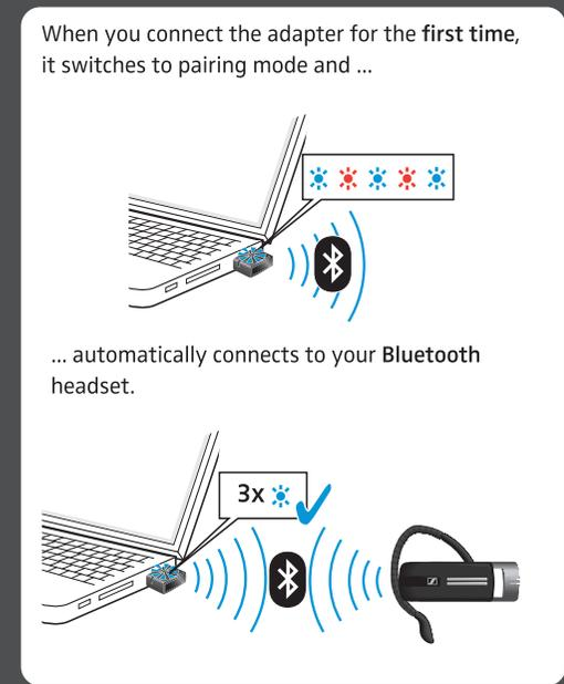
Pairing the BTD 800 USB with another headset | Forbin-delse af BTD 800 USB med endnu et hovedsæt | BTD 800 USB mit einem weiteren Headset verbinden | Conectar el BTD 800 USB con otro headset | Appairer le BTD 800 USB avec une oreillette supplémentaire | Collegamento di BTD 800 USB con un ulteriore headset | BTD 800 USB met een extra headset verbinden | Połączenie USB BTD 800 z kolejnym zestawem słuchawkowym
