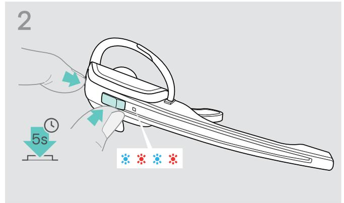
2 Halten Sie die Taste Verbindung und die Taste Audio gleichzeitig für 5 Sekunden gedrückt. Die LED Headset blinkt abwechselnd blau/rot.
