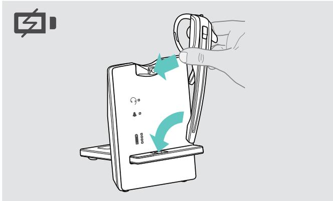
↑ Legen Sie das Headset in die Magnethalterung der Basisstation.
