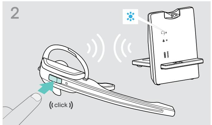
2 Drücken Sie am Headset die Taste Verbindung. Die LED Verbindung der Basisstation leuchtet blau.
