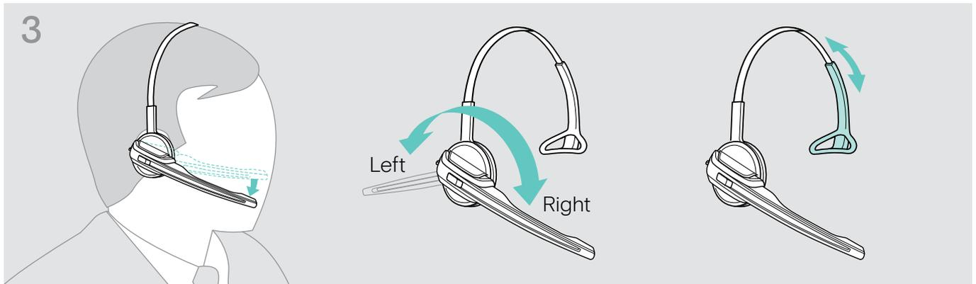
3 Drehen Sie den Mikrofonarm und stellen Sie das Headset so ein, dass das Ohrpolster angenehm auf Ihrem rechten oder linken Ohr aufliegt.
