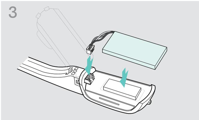
☛ Verbinden Sie den Stecker mit der Anschlussbuchse. Achten Sie dabei auf die Ausrichtung des neuen Akkus.
