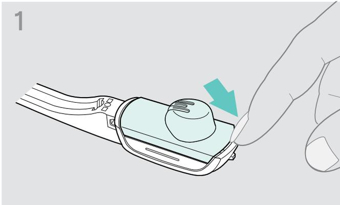
☛ Entfernen Sie den Ohrbügel oder den Kopfbügel (siehe Seite 12) und öffnen Sie das Akkufach.
