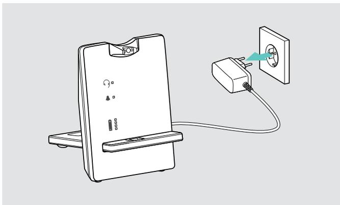
↑ Trennen Sie die Basisstation vom Stromnetz. Die Basisstation schaltet sich sofort aus, das Headset dadurch ca. 30 Minuten später.
