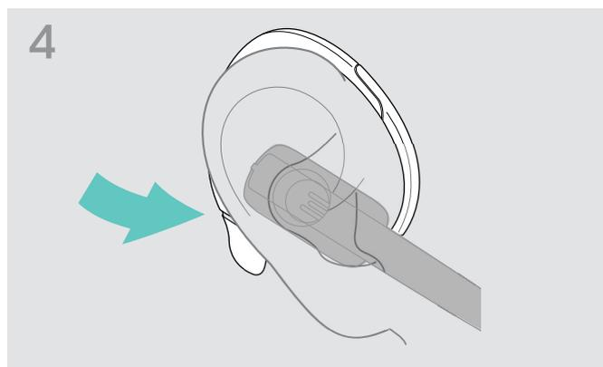
4 Formen Sie den flexiblen Ohrbügel so, dass das Headset angenehm und sicher sitzt.
