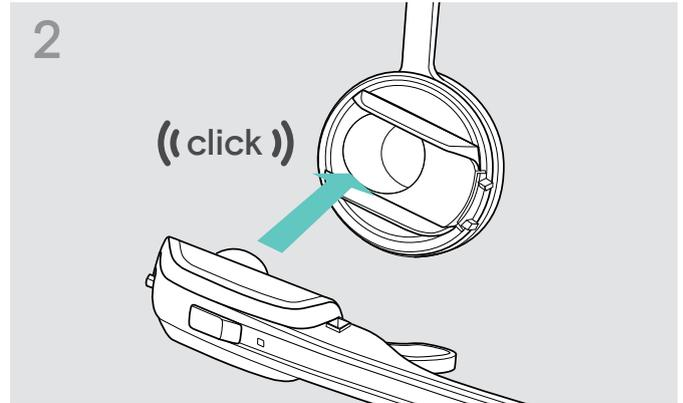
2 Stecken Sie das Headset in die Halterung des Kopfbügels.
