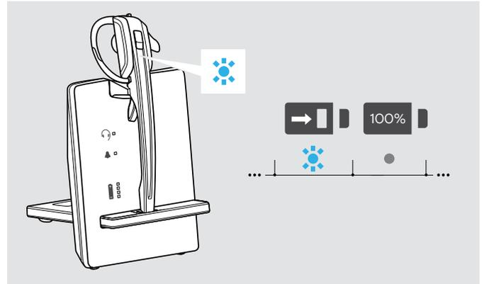
Die LED Headset leuchtet blau und der Akku wird geladen. Die LED Akku der Basisstation zeigt den Ladezustand an:
