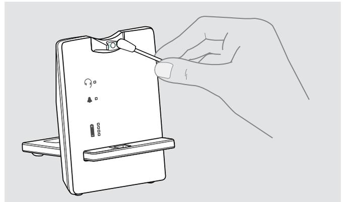
⬆ Reinigen Sie von Zeit zu Zeit die Ladepunkte des Headsets und der Basisstation mit einem Wattestäbchen.
