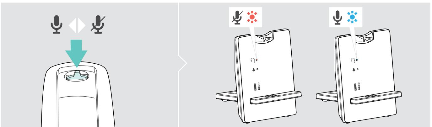
Drücken Sie die Taste Audio. Das Mikrofon wird stummschaltet. Während der Stummschaltung blinkt die LED Verbindung der Basisstation rot.
