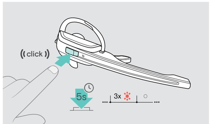
↑ Halten Sie die Taste Verbindung für 5 Sekunden gedrückt, um das Headset sofort auszuschalten. Die LED Headset blinkt 3-mal rot, das Headset ist vollständig ausgeschaltet. Die LED Verbindung der Basisstation leuchtet nach kurzer Zeit rot, die LED Akku der Basisstation erlischt.
