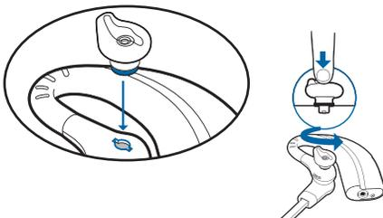
**HINWEIS** Stellen Sie beim Anbringen eines Gel-Ohrstöpsels sicher, dass der erhöhte Teil des Ohrstöpsels zur gewölbten Oberfläche des Headsets hin ausgerichtet ist (siehe Abbildung).
